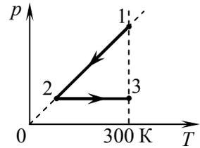
**Решение.** Поскольку при изобарном нагревании объём увеличился в 3 раза, температура также увеличилась в 3 раза. Значит,  $T_2 = 100$  К. На участке 1–2 объём газа остаётся постоянным. Теплоёмкость идеального одноатомного газа в изобарном процессе равна  $C_V = 3\nu R/2$ . Количество теплоты, отданное газом на участке 1–2, равно
