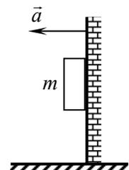
**Решение.** Чтобы груз не соскользнул вниз, нужно чтобы сила трения между грузом и стенкой уравновесила силу тяжести:  $F_{mp} = mg$ . Для неподвижного относительно стенки груза верно соотношение  $F_{mp} \leq \mu N$ , где  $\mu$  — коэффициент трения,  $N$  — сила реакции опоры, которая по второму закону Ньютона связана с ускорением стенки равенством  $N = ma$ . В итоге получаем:
