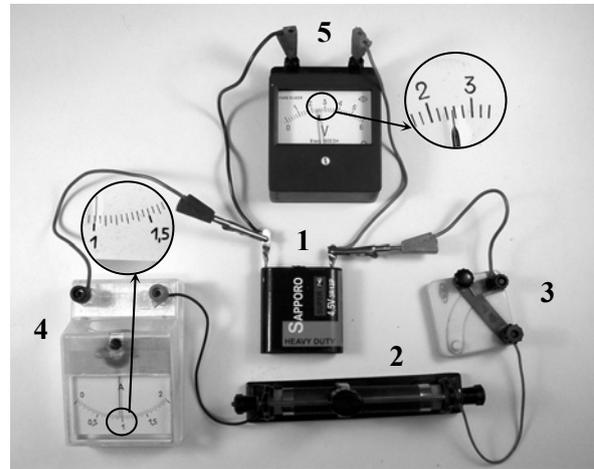
**Решение.** Показания вольтметра равны разности ЭДС и падения напряжения на внутреннем сопротивлении:  $U = \varepsilon - Ir$ . Из рисунков видно, что при силе тока в цепи  $I_1 = 0,5$  А вольтметр показывает напряжение  $U_1 = 3,2$  В, а при силе тока  $I_2 = 1$  А напряжение  $U_2 = 2,6$  В. Т. о. получаем систему двух уравнений, из которой находим ЭДС батарейки:
